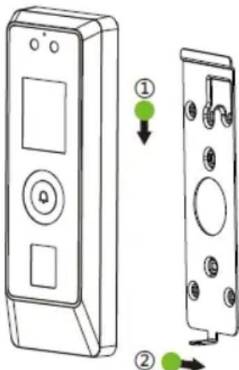
Fije el dispositivo a la placa posterior con un tornillo de seguridad
